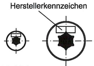
Senkkopf-Blechgewindeschraube  $\varnothing 4,8$  L = 11 mm für Kreuzadapter KA 43
